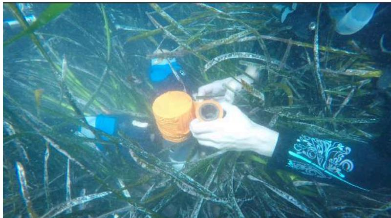
Enric Gomis toma notas de los parámetros de sondeo (arriba); Medición de la distancia del sedimento dentro y fuera del sondeador para calcular la profundidad máxima de hinca y el factor de compresión (centro); Sellado de la parte superior del sondeador antes de proceder a su extracción (abajo).
